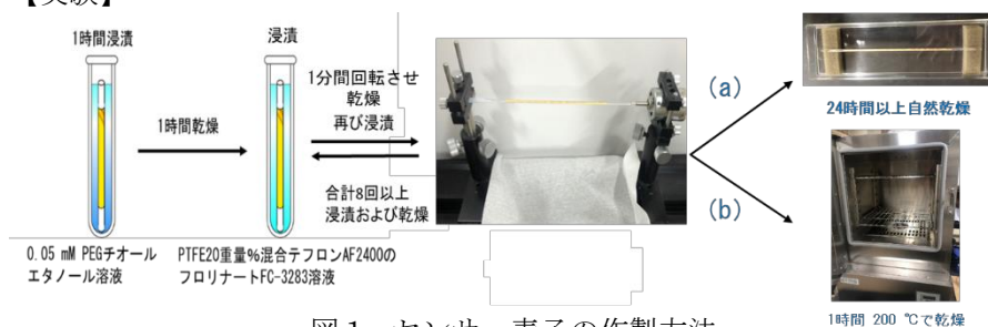
図1 センサー素子の作製方法
